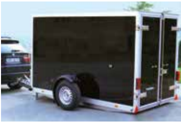
Anhänger in an- und abgehängtem Zustand absenkbar
